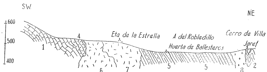
Fig. 8.—Corte geológico de la cuenca carbonífera namuriense desde la sierra al Cerro de la Villa. 1, calizas cambrianas; 2, pizarras cambrianas; 3, calizas carboníferas dinantienses; 4, conglomerado de base del namuriense; 5, complejo de pizarras, grawakas y areniscas namurienses, con capas de carbón; 6, roca sienítico-diorítica; 7, masa de pórfidos rojos sieníticos; 8, masa de gabros.
